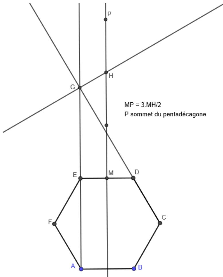
Partant d'un hexagone régulier ABCDEF, les demi-droites AE et CD se coupent en G, et la perpendiculaire à CD en G coupe la médiatrice de AB et DE en H. M étant le milieu de DE, le point P défini par  $MP = 3MH/2$  est le sommet du pentadécagone régulier approché opposé au côté de base AB.
