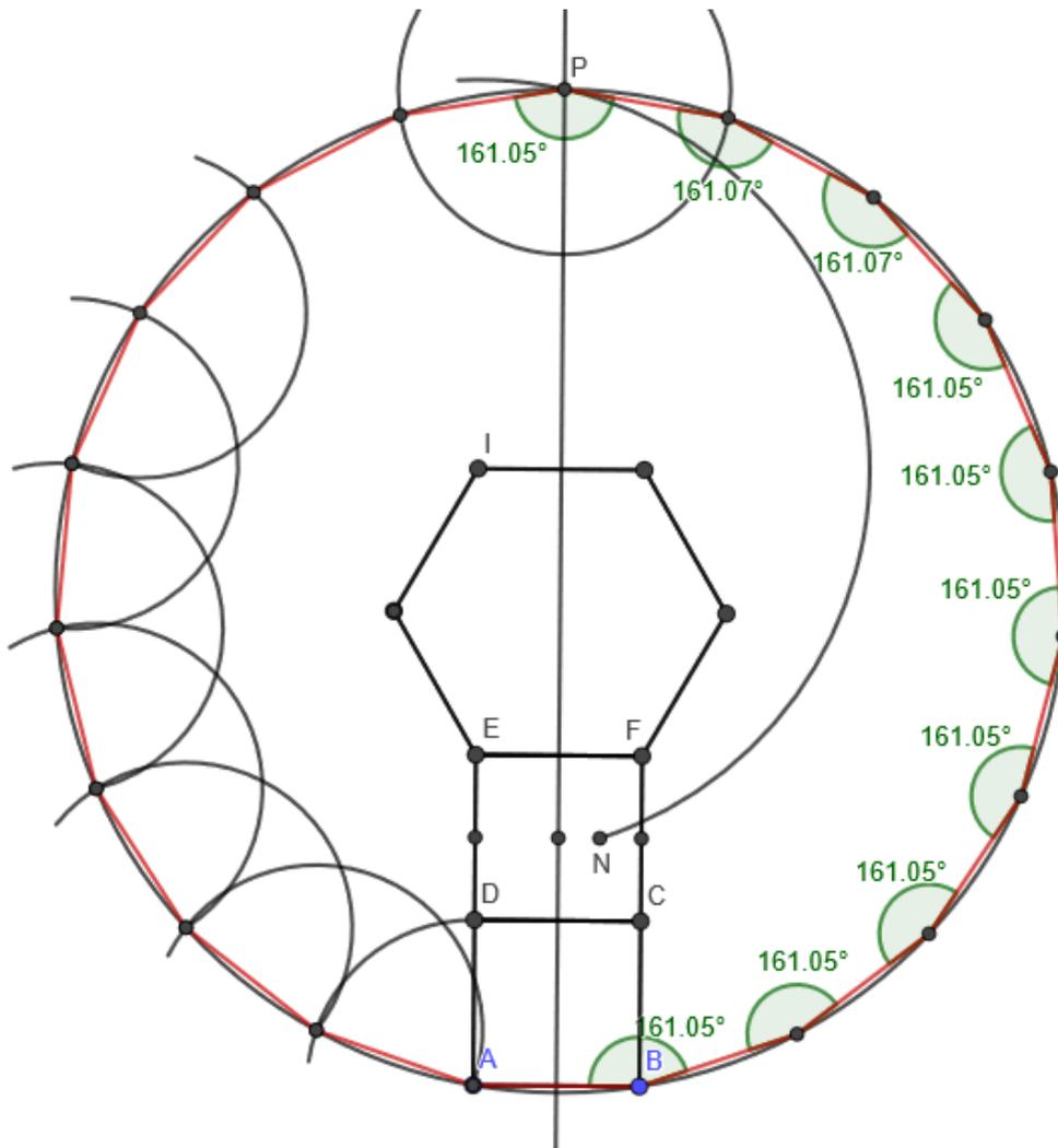
On peut voir que le résultat obtenu avec cette construction-ci est aussi proche, en ce qui concerne les angles, d'un ennéadécagone régulier que celui fourni par la construction du point 2) ci-dessus.
