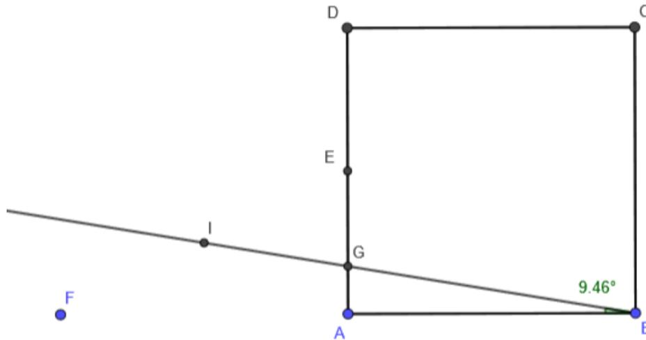
Sur cette figure, le point G est construit comme étant le centre de gravité du triangle BEF, F étant le symétrique de B par rapport à A, et I, le milieu d'EF. Pour confirmation,  $\tan(\pi/19) = 0,16687044862(1) \approx 1/6 = 0,16666666666\dots$  L'erreur vaut 0,12 %.
