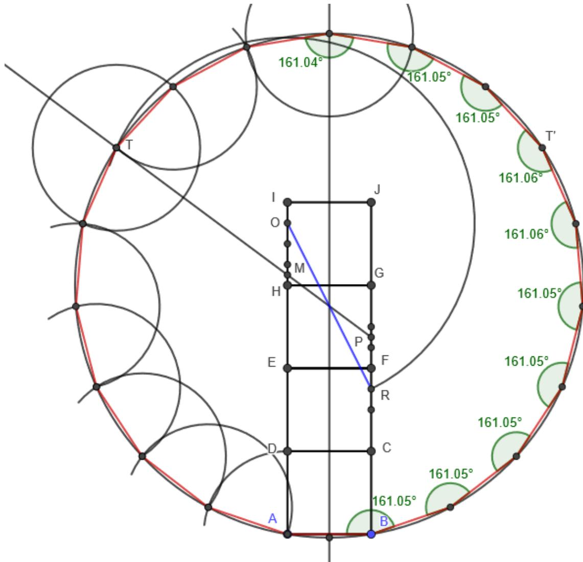
Partant d'un empilement de quatre carrés accolés ABCD, CDEF, EFGH, GHIJ, on marque : sur le côté CF, le point R tel que  $CR = 3CF/4$  ; sur le côté FG, le point P tel que  $FP = 3FG/8$ , et sur le côté HI, le point M tel que  $HM = HI/8$  et le point O tel que  $HO = 3HI/4$ . On trace la demi-droite PM et le cercle de centre O et de rayon OR : leur point d'intersection T est très proche d'un sommet de l'ennéadécagone régulier ayant AB pour côté de base.
