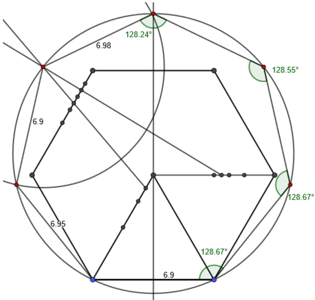
On vérifie cette construction par la même méthode que celle utilisée ci-dessus : Dans toujours le même repère orthonormé, les coordonnées des points H, I, J et K sont les suivantes : pour H,  $(9/16, \sqrt{3}/2)$  ; pour I,  $(-1/16, 7\sqrt{3}/16)$  ; pour J,  $(-21/32, 27\sqrt{3}/32)$  ; et pour K,  $(-19/32, 29\sqrt{3}/32)$ . Les équations des droites KH et JI s'écrivent alors, respectivement :
