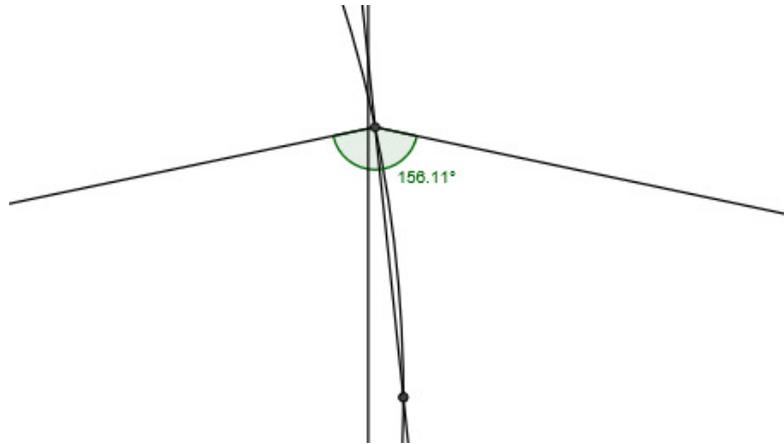
On voit aussi que si l'on choisit pour ce sommet le point d'intersection du cercle et de la médiatrice de AB, on obtient un pentadécagone un peu « pointu ». Le mieux est de prendre pour sommet du pentadécagone la projection orthogonale du point correspondant de la ligne polygonale sur la médiatrice de AB.
